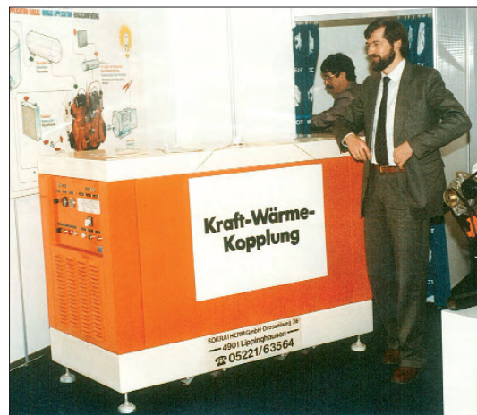
Bild 4. SOKRATHERM auf der Hannover Messe 1984 mit 40-kW-BHKW-Modul für Biogas
